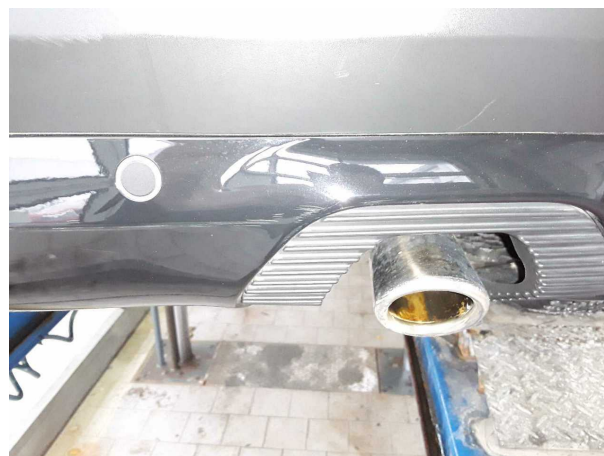
Beschädigung #4: Stossfänger hinten: Spoiler - verkratzt / verschürft
