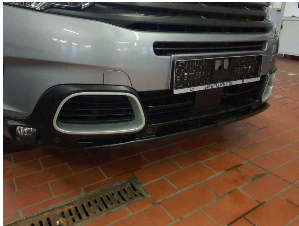
Beschädigung #2: Stossfänger vorn: Spoiler - verformt
