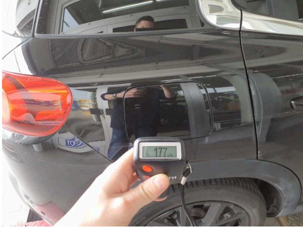
Nachlackierung 1: Seitenwand rechts
