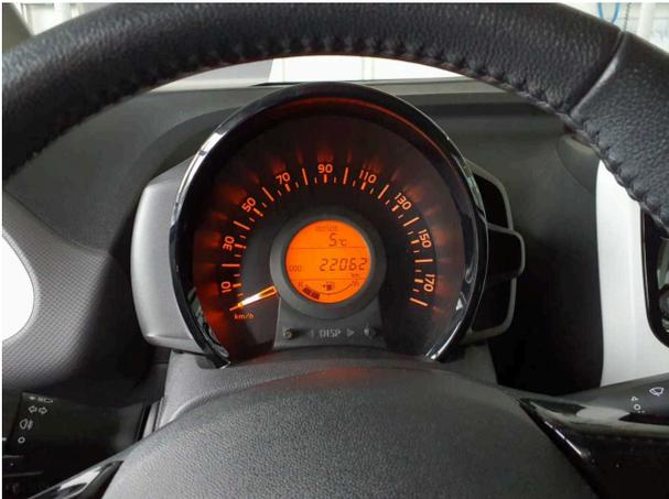
Abbildung 3: Kombiinstrument
