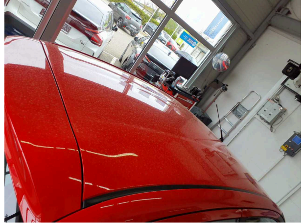
Beschädigung #1: Fahrzeugdach: Dach - Delle(n)
