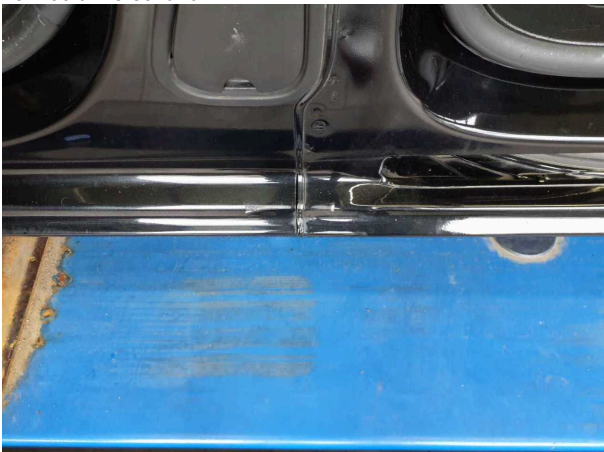
Beschädigung #3: Schweller links: Einstieg - verkratzt / verschürft
