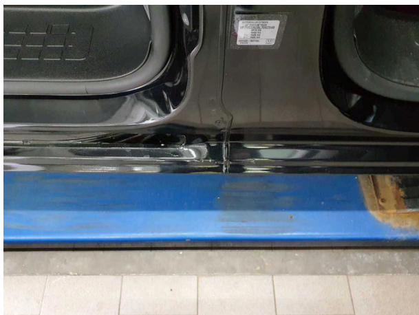
Beschädigung #5: Schweller rechts: Einstieg - verkratzt / verschürft
