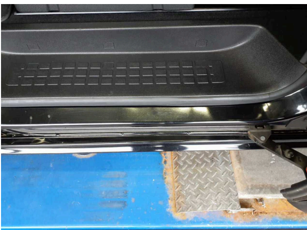
Beschädigung #3: Schweller links: Einstieg - verkratzt / verschürft
